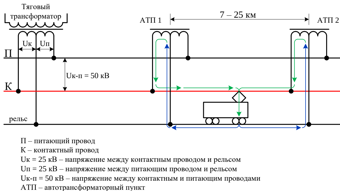
Рисунок 3.4. Схема системы электрической тяги 2 \times 25 \text{ кВ}
