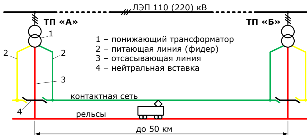
Рисунок 3.3. Схема системы электрической тяги 25 кВ
